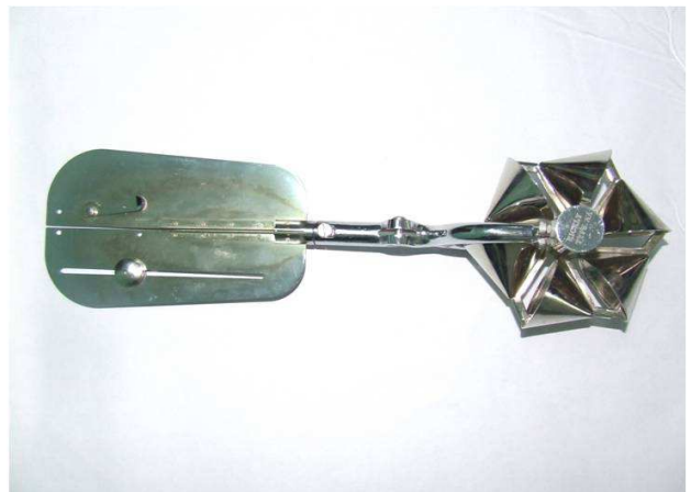
รูปเครื่องวัดกระแสน้ำ (Current Meter) แบบถ้วย (PYGMYE) ใช้กับกระแสน้ำที่มีความเร็วไม่สูง
